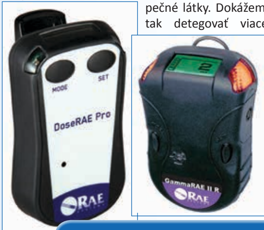
Osobné dozimetre DoseRae a GammaRae – oba prioritne využiteľné ako osobný dozimeter, ale zároveň ponúkajú možnosť určenia hranice medzi čistou a špinavou zónou
