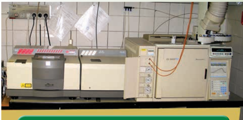
Plynový chromatograf s FTIR detektorom – infračervený detektor s Fourierovou transformáciou
